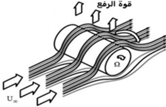
شكل 1: إنسياب الهواء حول إسطوانة دوارة و تولد قوة الرفع.
