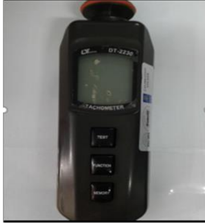
شكل 6: جهاز التاكوميتر المستخدم لقياس معدل الدوران.
